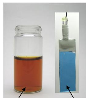
BBコロイド水溶液 PB膜析出電極
