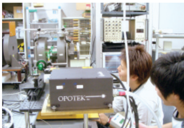
（課題研究）レーザー光を利用した分子性薄膜の磁気抵抗効果実験 [Experiments of magnetoresistance effect on molecular thin films using a laser] 光で誘起される磁性イオンの運動を電場や磁場で制御しています。
