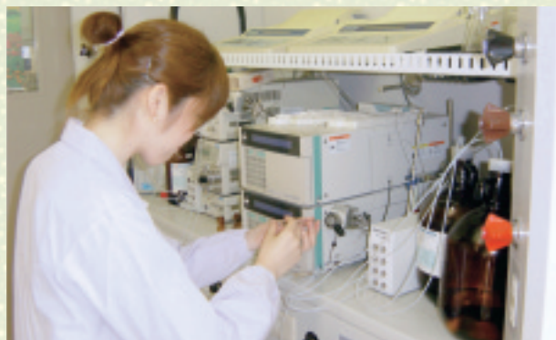
(課題研究) 高速液体クロマトグラフィーを使う有機化合物の分離・精製実験 [Isolation and purification of organic compounds by high performance liquid chromatography] 左写真のカラムクロマトグラフィーを機械化・高性能化した装置です。
