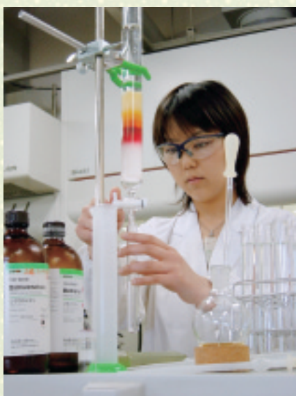
(課題研究) カラムクロマトグラフィー法による有機化合物の精製 [Purification of organic compounds by column chromatography] 分子とシリカゲル表面との水素結合力を利用して有機化合物を精製しています。
