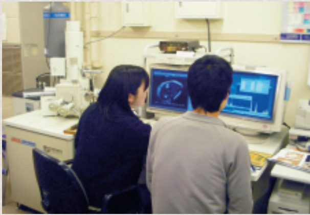
鉱物の化学組成分析とカソードルミネッセンス像の観察に用いる電子顕微鏡 [Scanning Electron Microscope with Energy dispersive X-ray spectroscopy (SEM-EDS) ]
